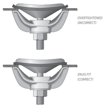
FIGURE 4 - GASKET INSTALLATION
