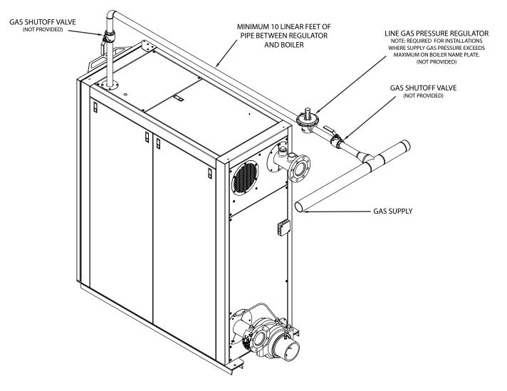
FIGURE 9 - ENDURA+ SINGLE BOILER GAS SUPPLY PIPING
