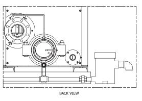
FIGURE 12 - CONDENSATE DRAIN PIPING FOR MULTIPLE ENDURA+ BOILERS
