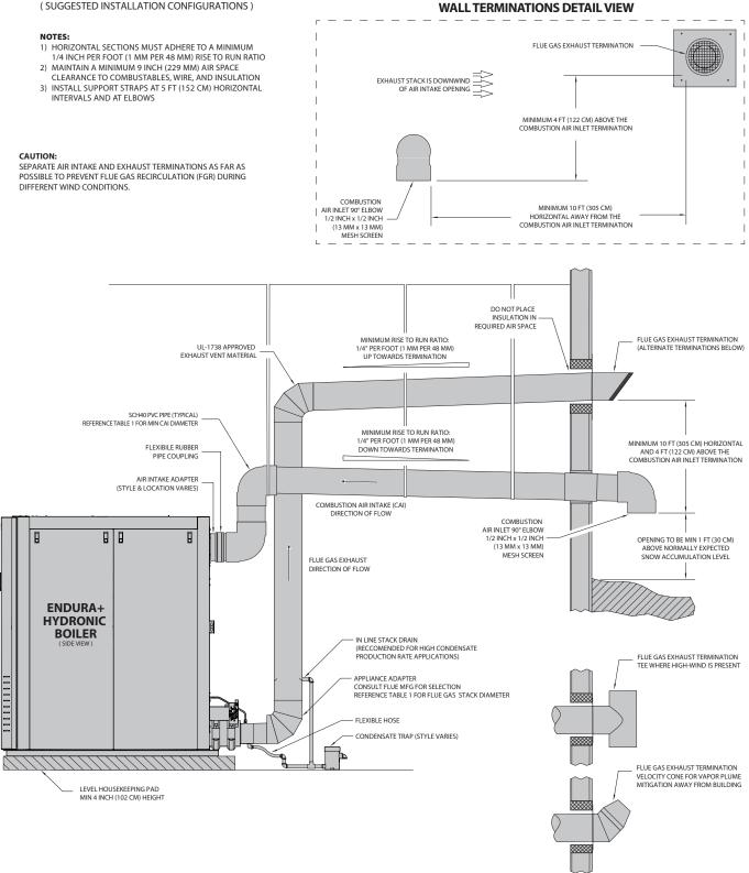
FIGURE 21 - SIDEWALL PENETRATION DETAIL
