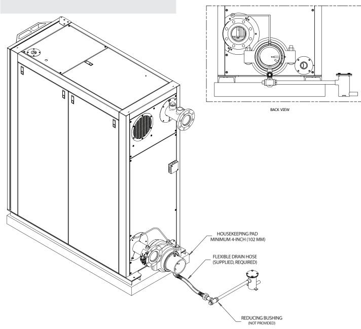
FIGURE 11 - CONDENSATE DRAIN PIPING FOR INDIVIDUAL ENDURA+ BOILER
