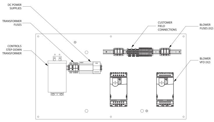
FIGURE 20 - ELECTRICAL MAIN POWER LAYOUT
