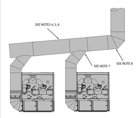
FIGURE 14 - TYPICAL COMMON FLUE GAS EXHAUST VENT LAYOUT
