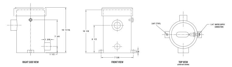
FIGURE 11 - MULTIPLE BOILER CONDENSATE DRAIN TRAP
