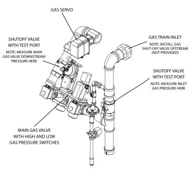
FIGURE 8 - TYPICAL GAS TRAIN PER MODULE (VARIES BY SIZE/MODEL)
