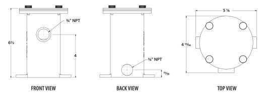
FIGURE 15 -SINGLE BOILER CONDENSATE DRAIN TRAP
