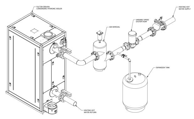
FIGURE 4 - SAMPLE PIPING LAYOUT, PRIMARY ONLY VARIABLE FLOW PIPING; SINGLE BOILER
