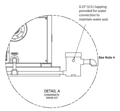
FIGURE 14 - CONDENSATE DRAIN PIPING FOR MULTIPLE ENDURA BOILERS
