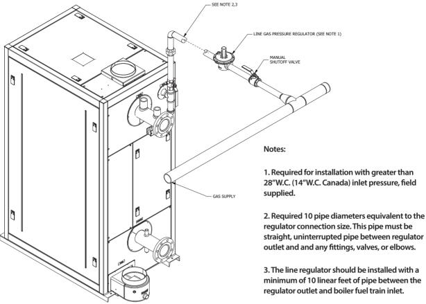
FIGURE 10 - ENDURA SINGLE BOILER GAS SUPPLY PIPING
