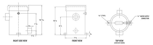
FIGURE 16 - MULTIPLE BOILER CONDENSATE DRAIN TRAP
